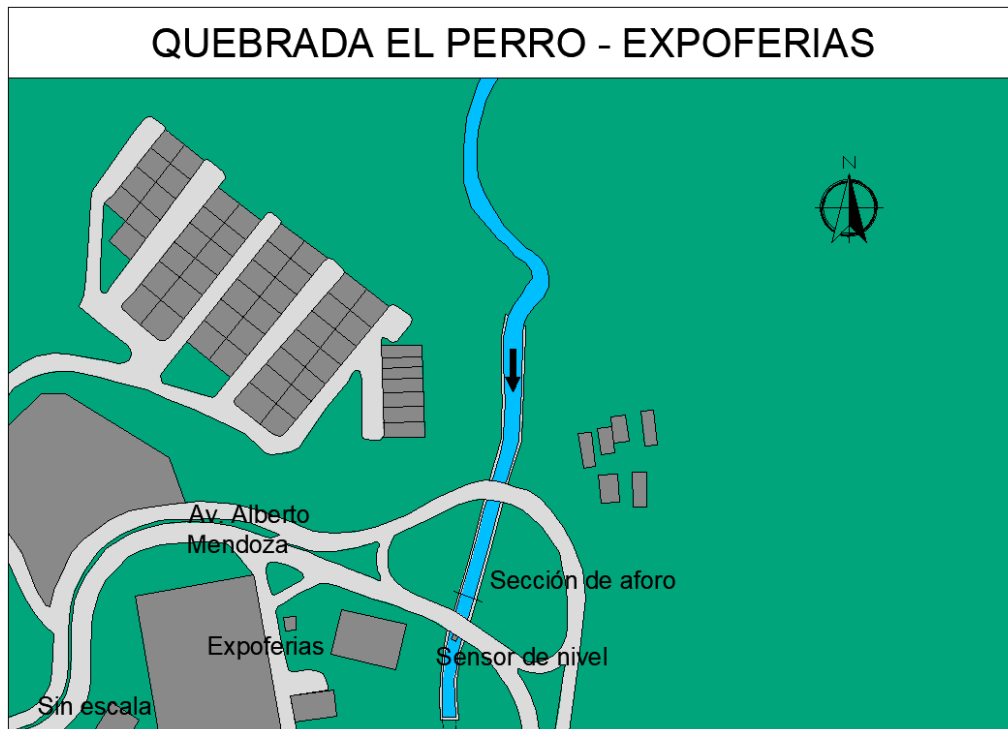
Figura 28. Vista en planta, Quebrada El Perro - Expoferias
